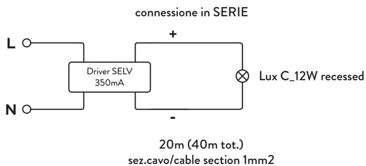
\* Verificare la tensione di ingresso supportata dagli alimentatori / Verify the input tension supported from drivers.
