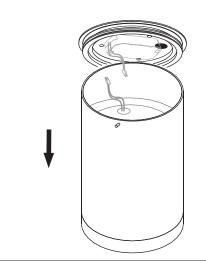
3- Praticare tre fori sul soffitto corrispondenti ai fori sul rosone, far passare i cavi di alimentazione attraverso il passacavo in gomma IP67. Inserire tre tasselli a espansione e fissare con tasselli adeguati (non inclusi) utilizzando oring e rondella come da immagine sotto.
